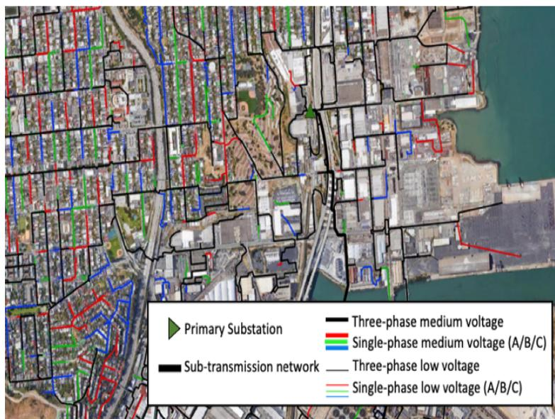
10 millones de nudos eléctricos. Siendo la red de gran escala, las redes diseñadas por el modelo tienen mucho detalle.
